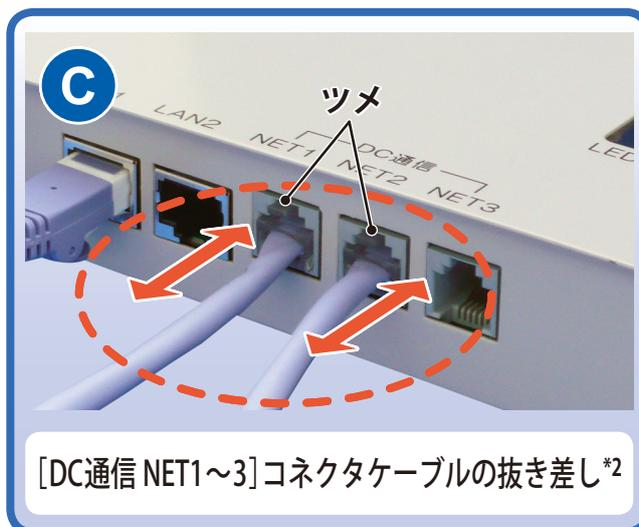
[DC通信 NET1～3]コネクタケーブルの抜き差し\*2
